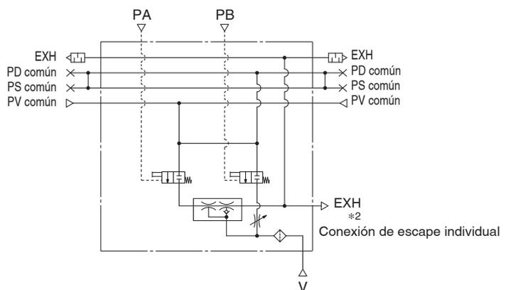
\*2 El modelo de escape completo dispone de una conexión de escape individual para cada estación
