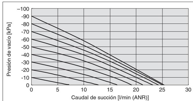
El caudal de succión real en el punto de succión varía en función de las condiciones de conexionado a la conexión de vacío. (La gráfica anterior muestra el valor cuando la conexión V es Ø 8.)
