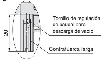
Especificación de rosca hembra de conexión PE del sistema de bomba de vacío (M3)
