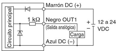
Tipo de salida de tensión: 1 a 5 V, Impedancia de salida: Aprox. 1 kΩ
