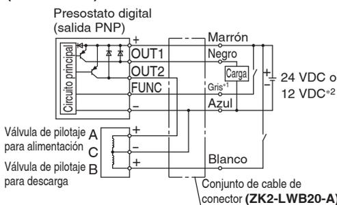
\*1 El cable gris (FUNC) se conecta cuando se acciona la válvula de alimentación mediante la función de ahorro energético (para adsorción de la pieza). (Para más detalles, consulta el manual de funcionamiento de ZK2-ZSV□□□-A en la web de SMC.)
