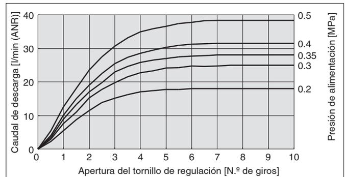
El caudal de descarga real en el punto de succión varía en función de las condiciones de conexionado. (La gráfica anterior muestra el valor del modelo ZK2B07.)
