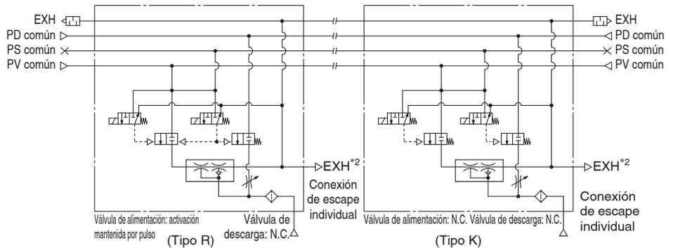
\*2 El modelo de escape completo dispone de una conexión de escape individual para cada estación
