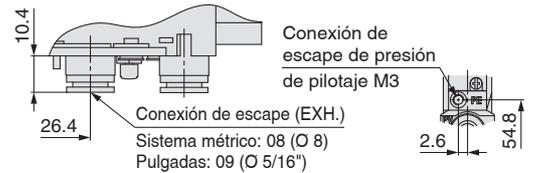
Para escape con silenciador de alta reducción de ruido Dimensiones de conexiones PS y PD \*1, \*4
