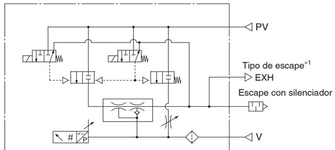
Válvula de alimentación: activación mantenida por pulso
