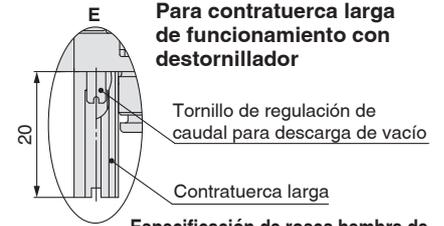
Especificación de rosca hembra de conexión PE del sistema de bomba de vacío (M3)
