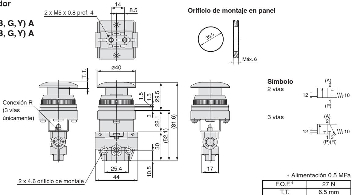
**Válvula con pulsador saliente (cilíndrico)**
