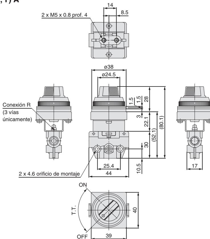
Orificio de montaje en panel
