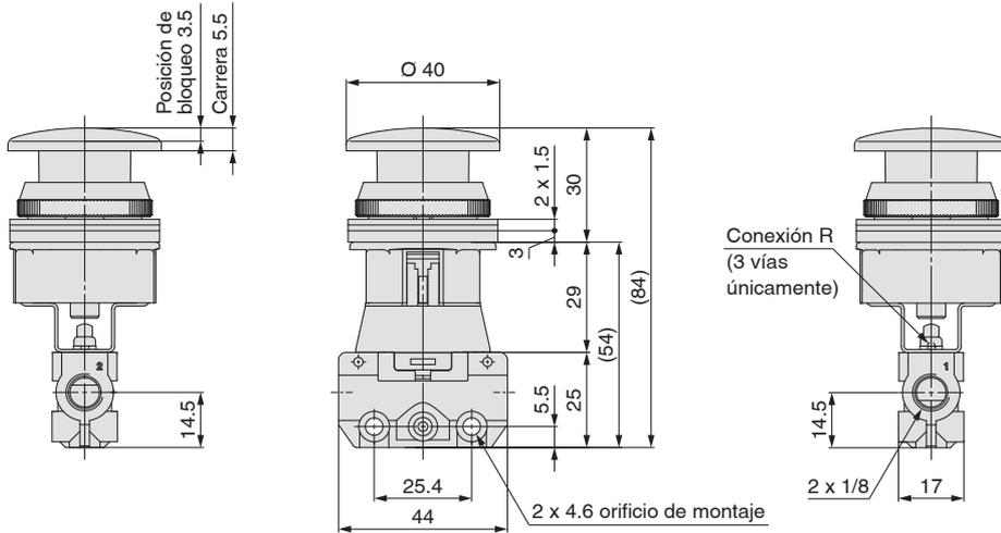
Orificio de montaje en panel
