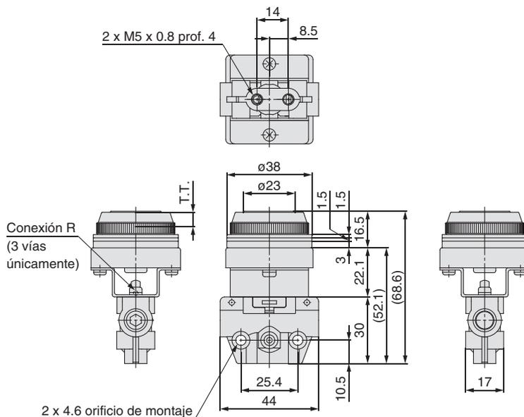
Orificio de montaje en panel
