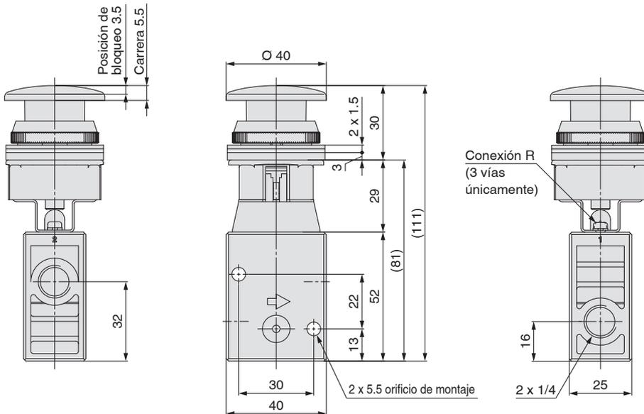
Orificio de montaje en panel
