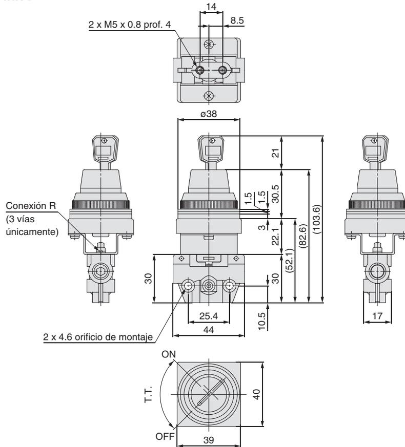
Orificio de montaje en panel
