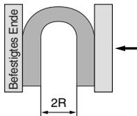
Den Schlauch bei einer Temperatur von 20° in U-Form biegen. Ein Ende befestigen und das andere langsam heranbiegen. Die Distanz 2R an der Stelle messen, an der die Änderungsrate des Außendurchmessers 5% beträgt.
