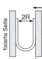
Biegen Sie den Schlauch bei einer Temperatur von 20° C in U-Form. Fixieren Sie eine Seite und schließen Sie schrittweise die Schlinge. Messen Sie den Wert 2R, wenn der Schlauch bricht oder gequetscht wird.
