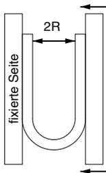
Biegen Sie den Schlauch bei einer Temperatur von 20° C in U-Form. Fixieren Sie eine Seite, schließen Sie dann schrittweise die andere Seite und messen Sie den Wert 2R an dem Punkt, an dem sich der Schlauch faltet, flachgedrückt wird o.Ä.
