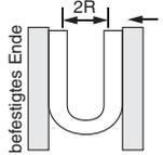
Den Schlauch bei einer Temperatur von 20°C in U-Form biegen. Dazu ein Ende befestigen und das andere langsam heranbiegen. Messen Sie die Distanz 2R an der Stelle, an der die Änderungsrate des Außendurchmessers 10% beträgt.
