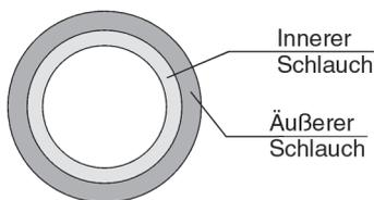
Schwer entflammbarer doppelwandiger Schlauch (Querschnitt)
