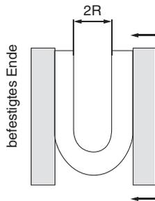
Den Schlauch bei einer Temperatur von 20°C in U-Form biegen. Dazu ein Ende befestigen und das andere langsam heranbiegen. Messen Sie die Distanz 2R an der Stelle, an der die Änderungsrate des Außendurchmessers 10% beträgt.
