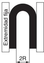
Doble el tubo en forma de U a una temperatura de 20 °C. Fije un extremo e incremente la curvatura gradualmente. Mida 2R cuando el porcentaje de deformación del diámetro del tubo sea del 5%.
