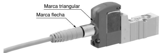
Nota) El conector debe montarse en la dirección adecuada. Asegúrese de que la flecha indicada en el conector está situada delante de la marca triangular de la válvula cuando utilice un conector de SMC (V 100-49-m). Procure no apretarlo en la dirección errónea ya que podría dañar los pins.
