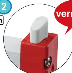
Die Druckluftzufuhr der Magnetventile kann individuell unterbrochen werden!
