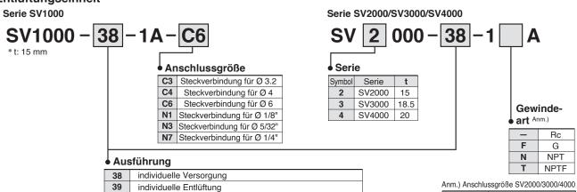
individuelle Versorgung + Entlüftung (doppelt gestapelt) 88 Bei der Serie SV3000 ist nur der Typ 10 mit den doppelt gestapelten
