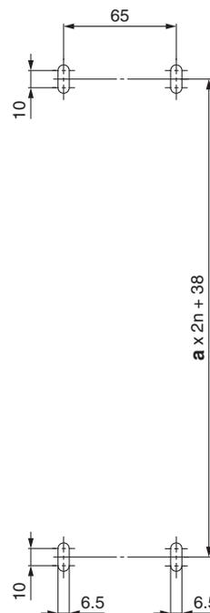
Posición del orificio de montaje
