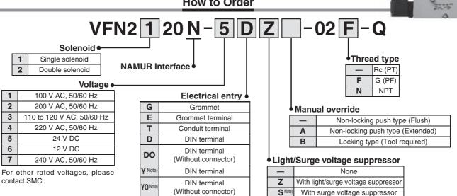
Note) Conforming to DIN 43650, Form B
