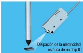
Disipación de la electricidad estática de un chip IC
