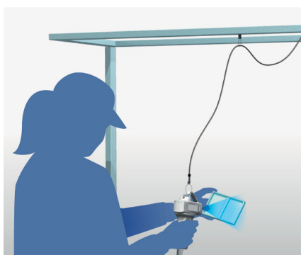
Устранение заряда и пыли на изделиях из пластика подвесным пневмопистолетом
