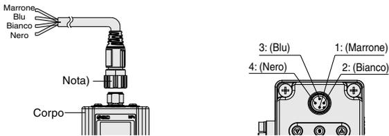
Nota) È disponibile anche il cavo angolare. È montato un connettore angolare volto verso sinistra (verso l'attacco di alimentazione). Non cercare di ruotarlo: il connettore non è girevole.
