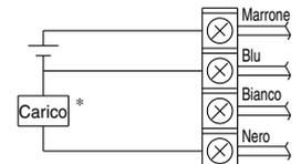
\* Quando si applicano 80 mA DC o più, si attiva il dispositivo di rilevamento di sovracorrente ed emette un segnale d'errore. (Numero d'errore "5")
