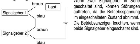
Wenn zwei Signalgeber in Serie geschaltet sind, können Störungen auftreten, da die Betriebsspannung im eingeschalteten Zustand abnimmt. Die Betriebsanzeigen leuchten, wenn beide Signalgeber eingeschaltet sind.
