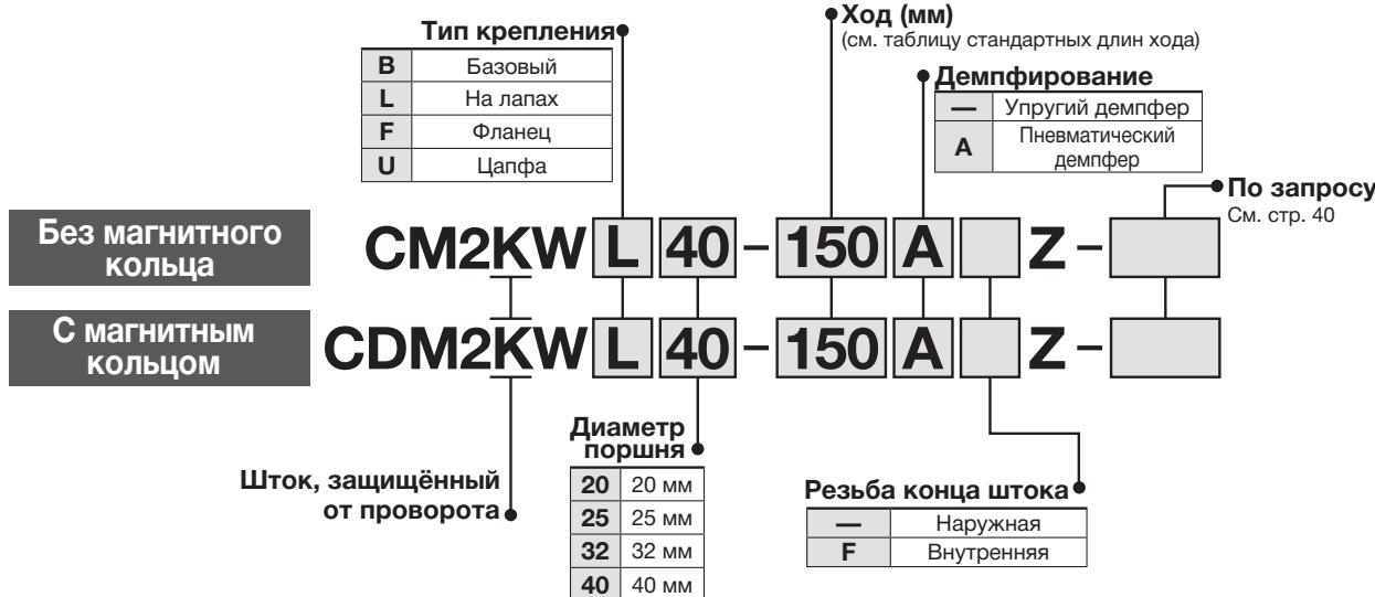
\* Датчики положения и крепления датчиков заказываются отдельно. Установка датчиков возможна только на цилиндры с магнитным кольцом.
