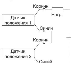
При последовательном соединении суммарное падение напряжения на датчиках может приводить к недостаточному напряжению на нагрузке в состоянии ВКЛ (датчики со светодиодами и индикаторами имеют значительное внутреннее сопротивление).
