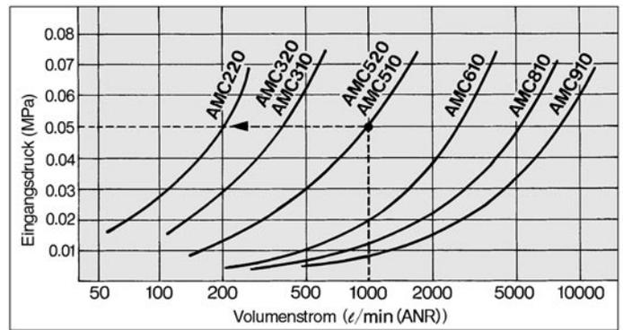
Lesen des Diagramms: Wenn das Modell AMC510 mit einem Volumenstrom von 1000 l/min (ANR) betrieben wird, beträgt der Eingangsdruck 0.05MPa.
