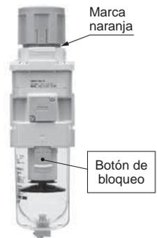
2. Cuando instales el vaso en los filtros AWG30(K)-B a AWG40(K)-B, instálalo de forma que el botón de bloqueo quede alineado con la ranura de la parte delantera (o trasera) del cuerpo para evitar así la caída del vaso o daños en el mismo.
