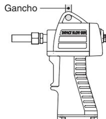
9. Cuando utilices o almacenes la pistola de soplado, confirma que no se dobla, gira ni se aplica una fuerza tensora ni carga momentánea en la conexión o el tubo. Esto puede provocar la fractura de los racores o el aplastamiento, rotura o aflojamiento de los tubos.
