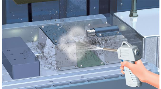
Para la separación de piezas adheridas por la presencia de aceite, etc.
