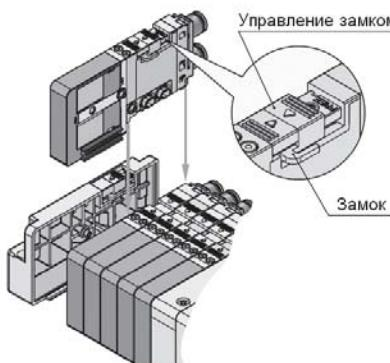
*Рис.7.23. Модульный монтаж пневмораспределителей с помощью индивидуальных замков*
