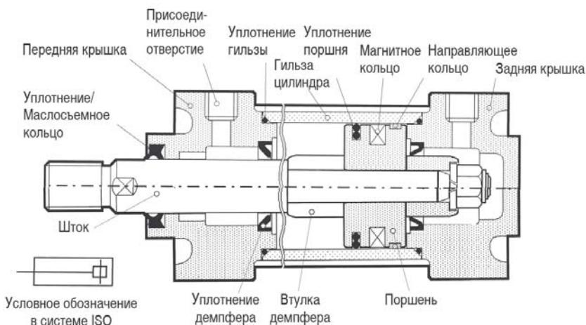
Рис. 6.1. Конструкция цилиндра двухстороннего действия с демпфированием в конце хода
