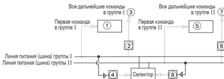
Рис. 8.28. Блок-схема переключения шин
