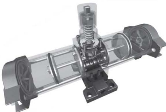
Рис.6.15. Конструкция усилителя давления
