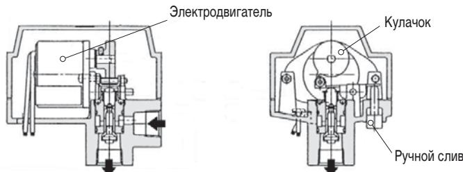
*Рис. 4.18. Автоматический конденсатоотводчик с электроприводом*
