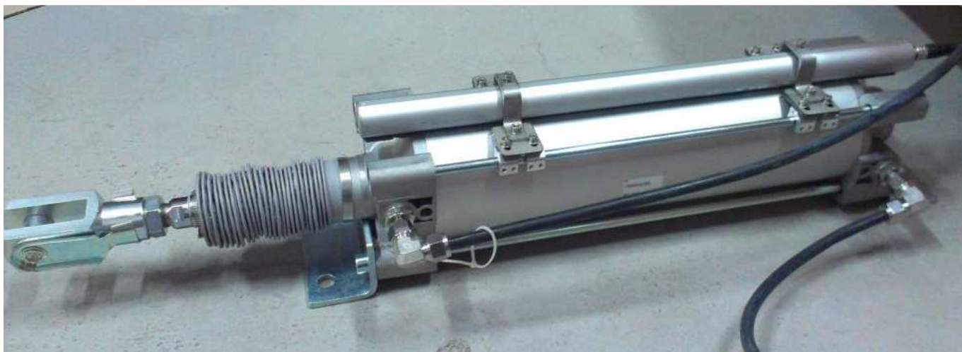
Рис. 1 Цилиндр серии С96 с установленным датчиком типа ВТЛ
