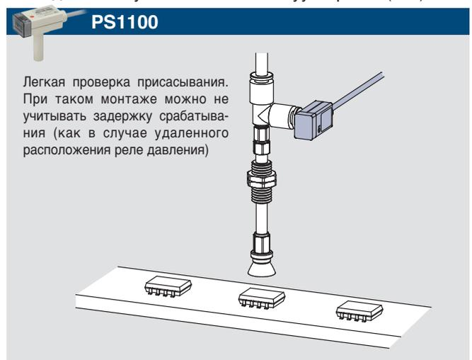
Проверка присасывания влажных заготовок
