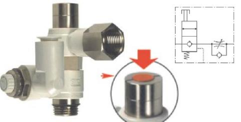
Может использоваться для остановки в промежуточном положении или для предотвращения падения груза при аварийной ситуации, а также для сброса остаточного давления с помощью нажатия кнопки.
