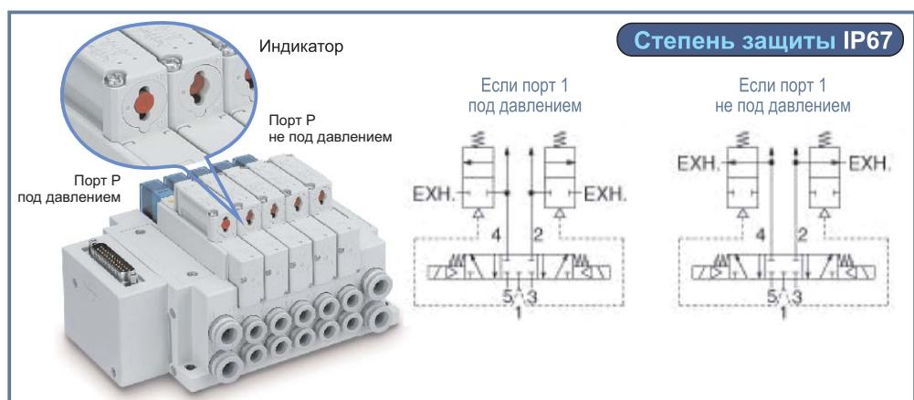
Давление в портах 4 (A) и 2 (B) автоматически сбрасывается при сбросе давления из порта 1 (P).
