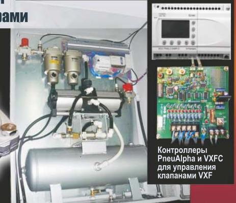
Контроллеры PneuAlpha и VXFC для управления клапанами VXF
