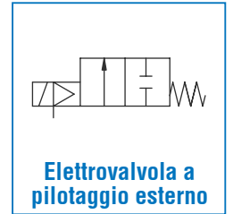
Elettrovalvola a pilotaggio esterno per refrigerante ad alta pressione Serie SGH
