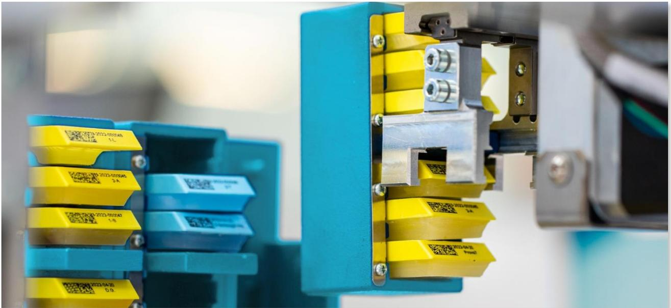
Particolare della pinza elettrica della famiglia LEHZ di SMC utilizzata per la movimentazione dei blocchetti all'interno della macchina FlexPath™ Blox di Inpeco
