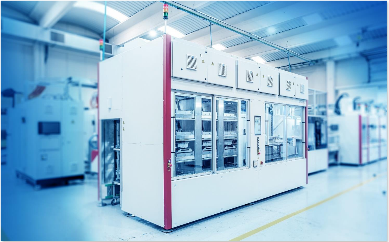
Stazione per test di burn-in di OBC, di IPTE.
