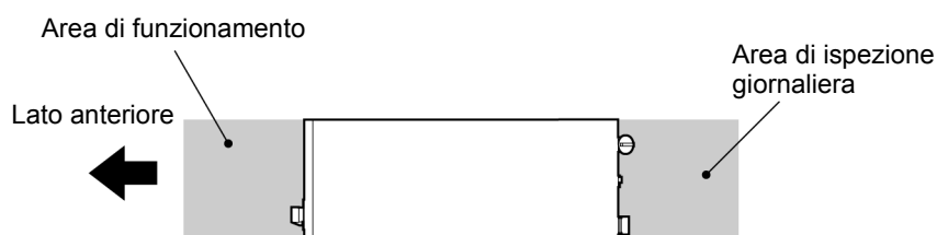
Figura 3-3 Posizione di installazione
