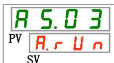
**5.** Sélectionnez la modification de l'augmentation de température d'évacuation du fluide calorigène sur le tableau ci-dessous avec la touche [▲] ou [▼], et confirmez avec la touche « SEL ».
