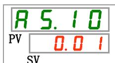
**19.** Sélectionnez la température de détection pour la chute de pression d'évacuation du fluide calorigène sur le tableau ci-dessous avec la touche [▲] ou [▼], et confirmez avec la touche « SEL ».
