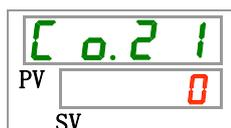
**42.** Sélectionnez le signal calibré de lecture du signal d'entrée de contact 2 sur le tableau ci-dessous avec la touche [▲] ou [▼], et confirmez avec la touche « SEL ».
