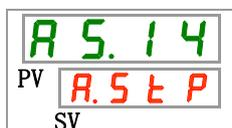
**27.** Sélectionnez la modification de détection du signal d'entrée de contact 2 sur le tableau ci-dessous avec la touche [▲] ou [▼], et confirmez avec la touche « SEL ».
