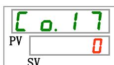
**34.** Sélectionnez le signal calibré de lecture du signal d'entrée de contact 1 sur le tableau ci-dessous avec la touche [▲] ou [▼], et confirmez avec la touche « SEL ».
