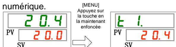
Affiche la température du fluide calorigène à l'évacuation duquel le fluide est alimenté à l'appareil du client. Cette température ne prend pas le décalage de températures en considération
