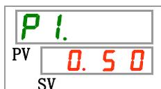
La pression du fluide calorigène à l'évacuation duquel le fluide alimente l'appareil du client, s'affiche.
