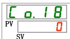
**36.** Sélectionnez le signal calibré de détection du signal d'entrée de contact 1 OFF sur le tableau ci-dessous avec la touche [▲] ou [▼], et confirmez avec la touche « SEL ».
