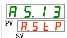
**25.** Sélectionnez la modification de détection du signal d'entrée de contact 1 sur le tableau ci-dessous avec la touche [▲] ou [▼], et confirmez avec la touche « SEL ».
