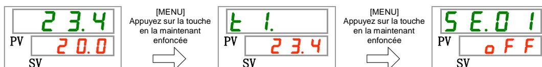
Réglage et vérification du réchauffage
