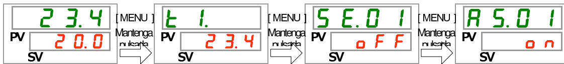
Ajuste y comprobación del sonido de zumbador de alarma
