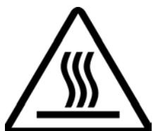
Dieses Symbol warnt vor möglicherweise heißen Oberflächen oder Verbrennungsgefahr.
