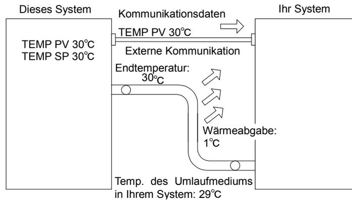
Abb. 8-6 Beispielhafte Ausgleichsfunktion
