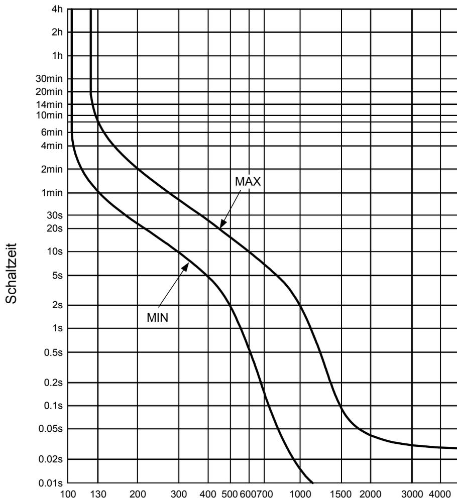
Stromstärke (in % der Kapazität der Überstromschutzeinrichtung dieses Produkts)
