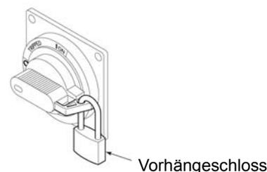
Abb. 1-15 Verriegelung des Hauptschalters
