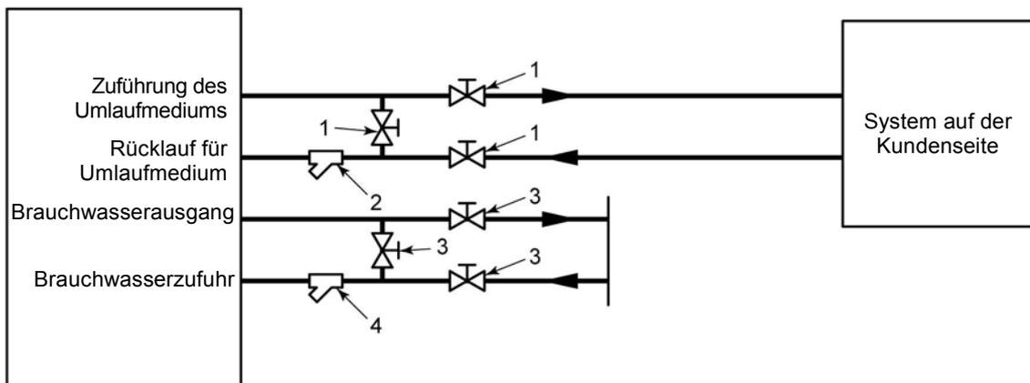
Abb. 3-11 Empfohlene Leitungsanordnung
