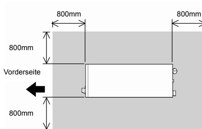
Abb. 3-2 Empfohlene Installationsanordnung
