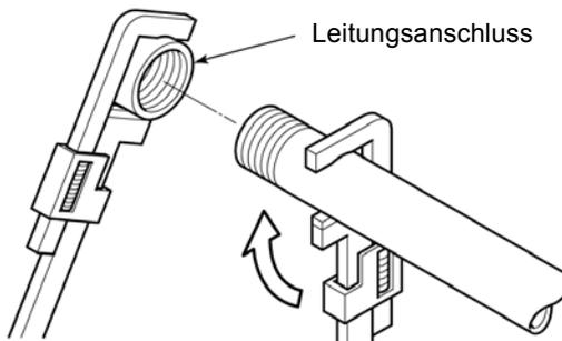
Abb. 3-10 Festziehen der Leitungsanschlüsse
