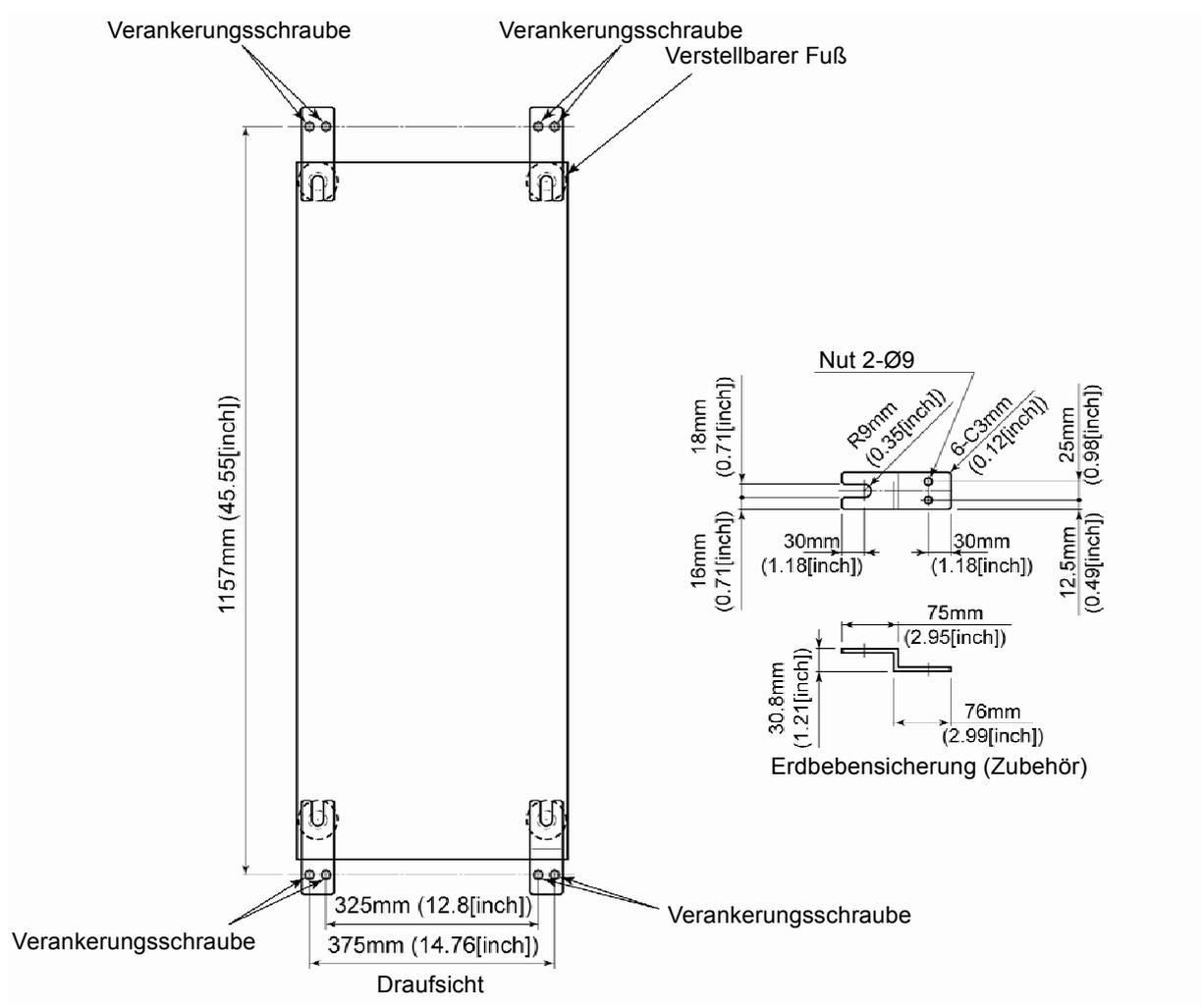
Abb. 8-12 Montageposition der Verankerungsschrauben
