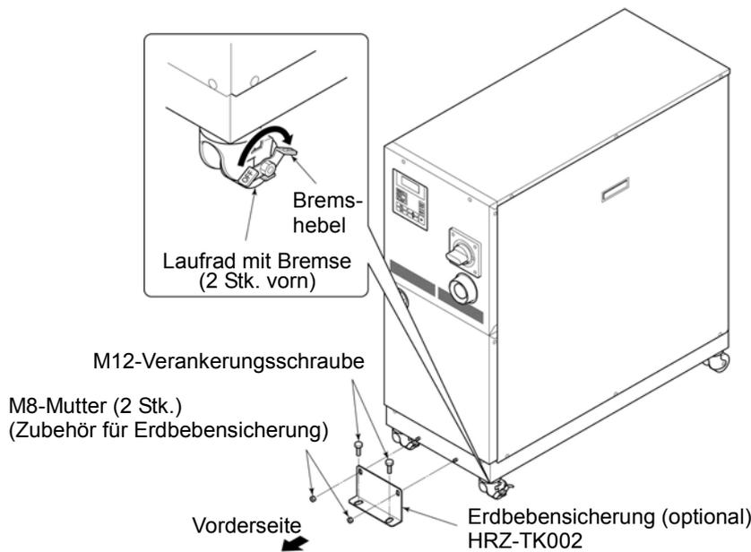
Abb. 3-3 Anbringen der Erdbebensicherung
