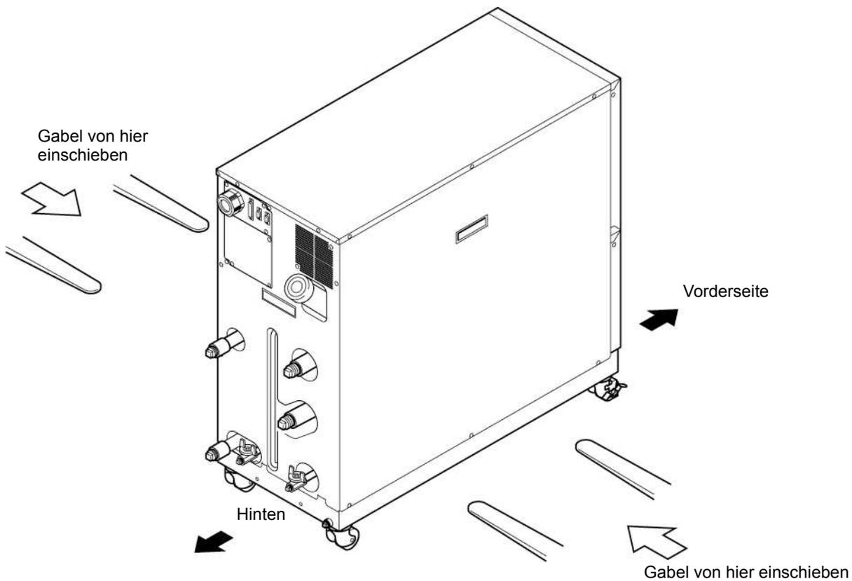
Abb. 3-1 Transport mit einem Gabelstapler
