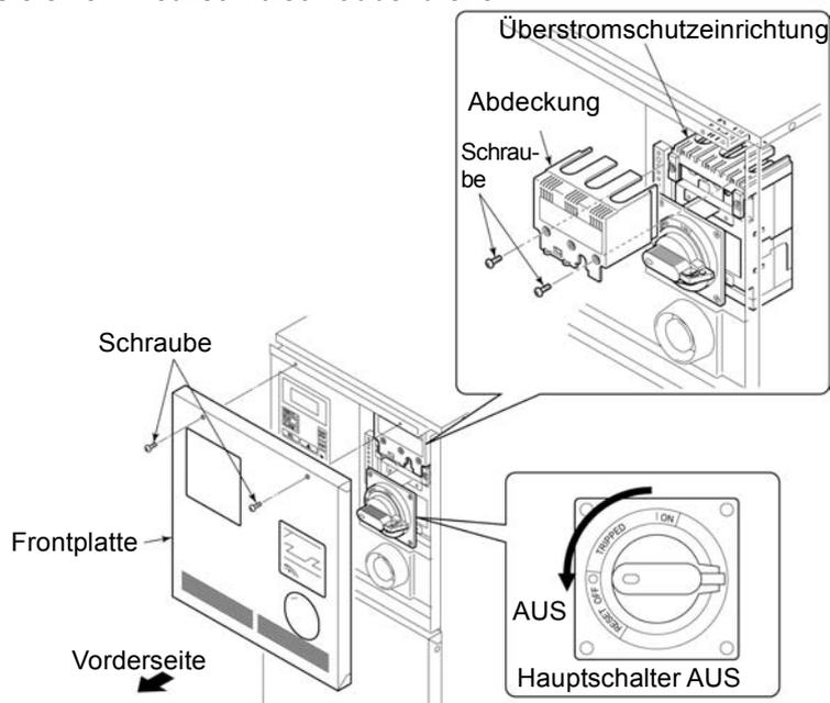
Abb. 3-7 Ausschaltung des Hauptschalters und Entfernung von Frontplatte/Unterbrecherabdeckung
