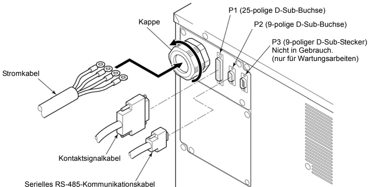
Abb. 3-8 Anschluss der Stromleitung und der seriellen Schnittstelle
