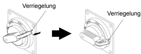
Abb. 1-14 Herausziehen der Verriegelung
