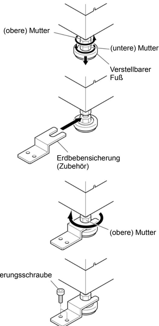
Abb. 3-4 Anbringen der Erdbebensicherung
