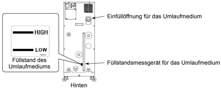
Abb. 4-1 Einfüllöffnung und Füllstandsmessgerät für das Umlaufmedium
