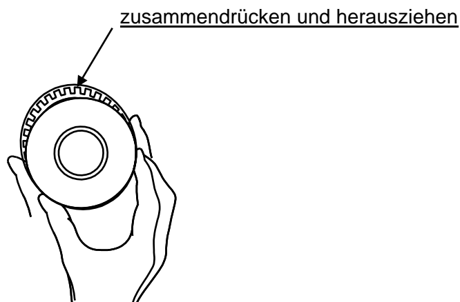
Abb. 6 Ausbau der Kolbendichtung
