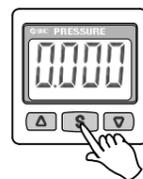
2. [P\_1] o [n\_1] e il valore di regolazione verranno visualizzati in alternanza.
