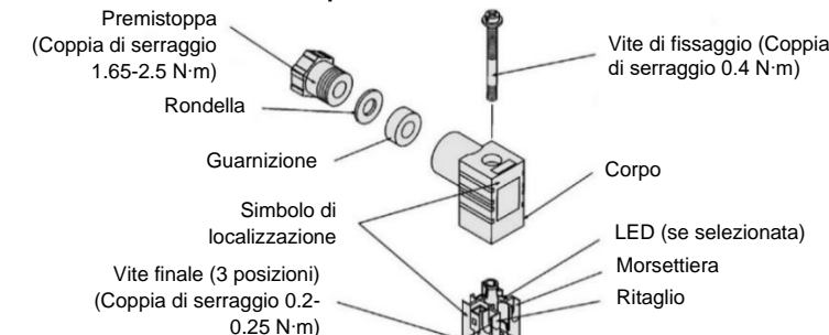
Figura 7. Costruzione del connettore DIN JSX10
