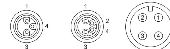
Connettore M8 3 pin    Connettore M8 4 pin    Connettore M12 4 pin
