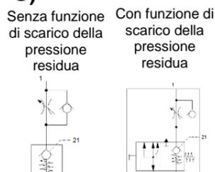
Questo prodotto è progettato per l'arresto temporaneo di un attuatore. In assenza di segnale di pilotaggio, la valvola di ritegno si chiude, impedendo il flusso da 2 a 1 e l'attuatore non si muove. Quando viene applicato il segnale di pilotaggio, la valvola di ritegno si apre, consentendo il passaggio dell'aria da 2 a 1 e il movimento dell'attuatore. Il pulsante dell'azionamento manuale apre tutti i percorsi del flusso (2→1, 21 e attacco di scarico).
