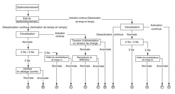
Vérifiez les caractéristiques de charge (1) —— Tension d'activation > Tension de charge - Chute de tension interne Vérifiez les caractéristiques de charge (2) —— Courant de désactivation > Courant de fuite
