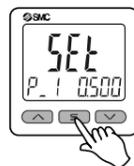
(2) Modifier la valeur de consigne avec la touche ▲ ou ▼, puis appuyez sur la touche [S] pour régler la valeur. Le réglage passe ensuite au paramètre hystérésis. (La fonction snapshot peut être utilisée).
