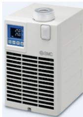
Ce produit utilise une pompe intégrée pour faire circuler un liquide (eau ou solution aqueuse d'éthylène glycol (20%) à une température constante, contrôlée par des modules thermoélectriques (Peltier). Ce liquide circulant refroidit les pièces de la machine du client qui génèrent de la chaleur.
