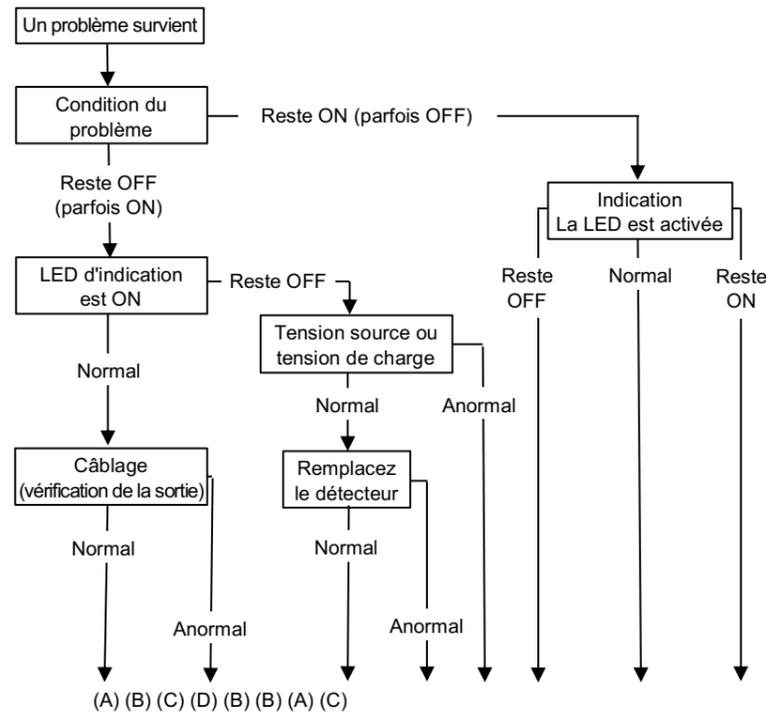
(A) = Échec de la sortie du commutateur (remplacer)
