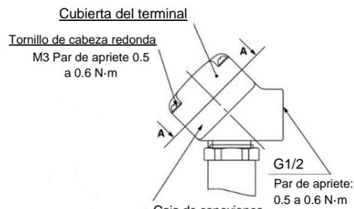
Figura 5. Caja de conexiones
