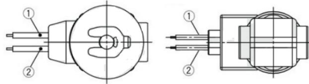
Figura 3. Salida directa a cable y salida directa a cable con PCB
