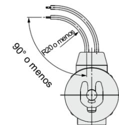
Figura 2. Curvatura del cable
