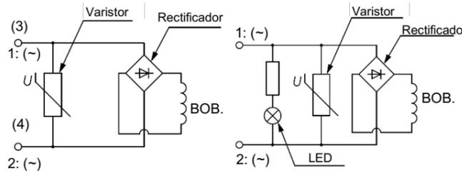
Figura 11. Terminal DIN con LED y supresor de picos de tensión
