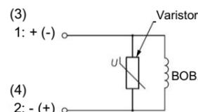
Figura 9. Salida directa a cable / Terminal DIN / Conducto con supresor de picos de tensión / Conector M12 (3,4)
