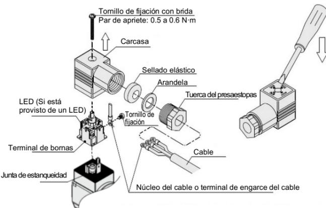
Figura 5. Diseño del conector DIN para JSX20/30
