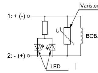
Figura 10. Terminal DIN con LED y supresor de picos de tensión
