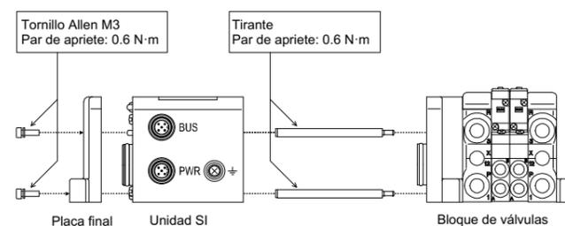
Mantenga unidas la unidad SI y los módulos de entrada / salida para garantizar que no exista un hueco entre ellas mientras aprieta los tornillos. Apriete los tornillos al par de apriete adecuado especificado (0.6 N·m).
