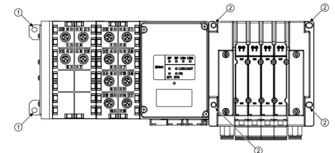
Todos los bloques se montan usando 6 tornillos (excepto VQC4000, que usa 5 tornillos).
