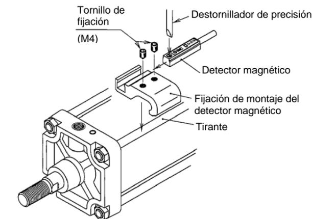
El par de apriete del tornillo de fijación M4 debe ser entre 1.0 y 1.2 N·m.
