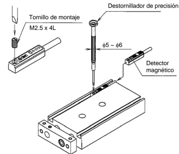
El par de apriete del tornillo de montaje M2.5 debe ser entre 0.05 y 0.1 N·m.
