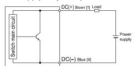
• D-T79# / D-T99(V)# (source input mode)
