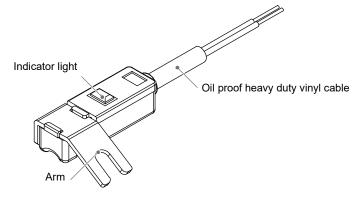
D-S99# / D-S9P# / D-T99# (Right hand mounting shown)
