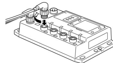
**ANMERKUNG** Jeden unbenutzten Anschluss der GW-Einheit mit einer wasserdichten Kappe versehen. Durch ordnungsgemäße Verwendung geeigneter Kappen kann die Gehäuseschutzklasse IP65 erreicht werden. (Anzugsdrehmoment: 0,1 Nm für M12)
