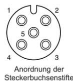
**ANMERKUNG** Massekabel von max. 100 Ω am PE-Anschluss anschließen. (DRAIN- und PE-Klemme des DeviceNet sind in der Gateway-Einheit über einen Kondensator verbunden.)
