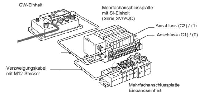
**ANMERKUNG** Ist keine Eingangseinheit am Anschluss (C1) oder (0) der SI-Einheit angeschlossen, ist ein Abschlussstecker anzubringen.
