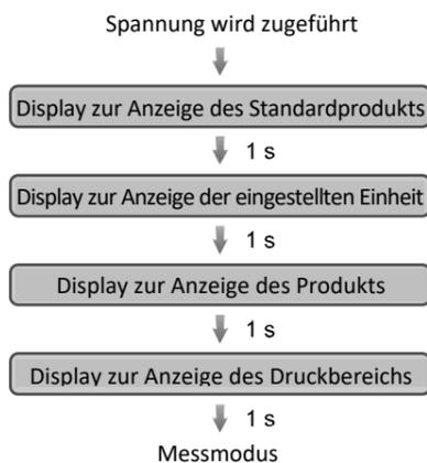
Einstellen der ON- und OFF-Punkte des Druckschalters.
