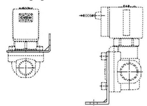
Abb. 1: VXED2130 (links) und VXED2140:2260 (rechts) Befestigungselemente
