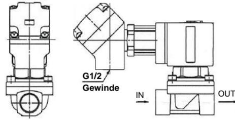
Abb. 8 VXED2130 Klemmenkasten-Ausführung
