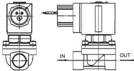
Abb. 3. VXED2130 Kabeleingang für Schutzrohranschluss
