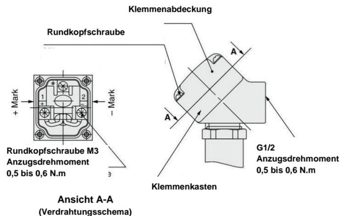
Abb. 9 Klemmenkastenverdrahtung
