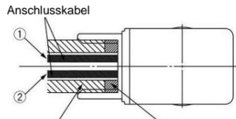
Kabeleingang mit Schutzrohr
