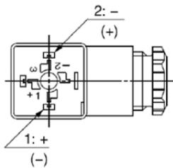
Abbildung 5 Polarität des DIN-Steckers
