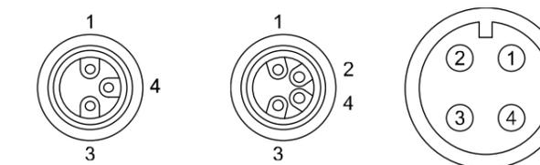
M8-Stecker, 3-polig      M8-Stecker, 4-polig      M12-Stecker, 4-polig
