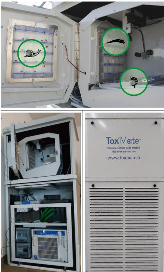
Fonctionnement de ToxMate : dans la partie supérieure, les invertébrés sont observés avec des caméras de vision. En bas à gauche, on peut voir dans la partie inférieure du ToxMate le système de contrôle de la température de SMC.
