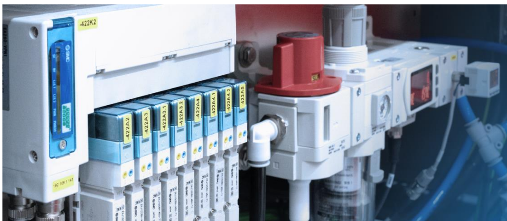
La génération de vide (à gauche) s'effectue par l'intermédiaire d'un îlot modulaire qui intègre des éjecteurs, des nœuds de bus et un système de surveillance.
