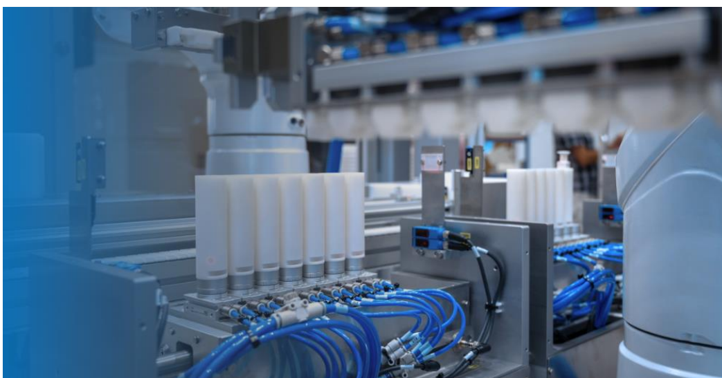
Les pièces sont tournées de 15 degrés à l'aide des plus petits actionneurs rotatifs pneumatiques de SMC disponibles sur le marché.
